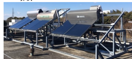
図3 自然循環型太陽熱給湯設備の実証試験の様子
